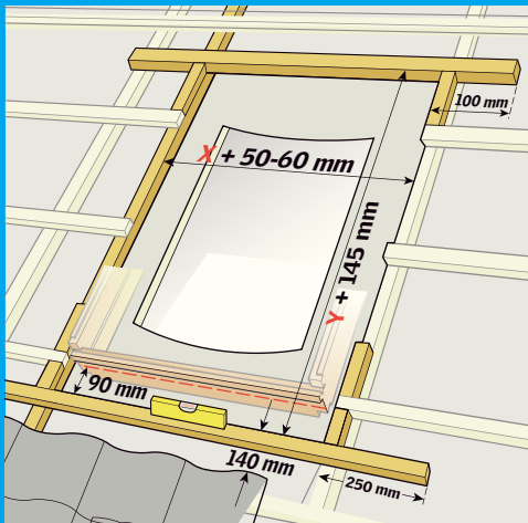
Velikost montážního otvoru při zapuštěném osazení střešního okna
